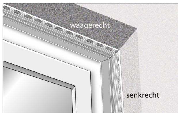
3. Eventuell überstehenden Montageschaum bündig zum Blendrahmen entfernen. Schutzfolie des Schaumklebebandes an einem Ende der **Dichtleiste** ein Stück ablösen und **Dichtleiste** mit der Klebefläche des Schaumklebebandes am oberen Ende des Blendrahmens fixieren. Schutzfolie schrittweise nach unten abziehen und die **Dichtleiste** nach und nach an den Blendrahmen mit dem Montageroller andrücken. Bei WDVSystemen auf eine ausreichende Blendrahmenüberdeckung gem. DIN 4108 Beiblatt 2 achten.
