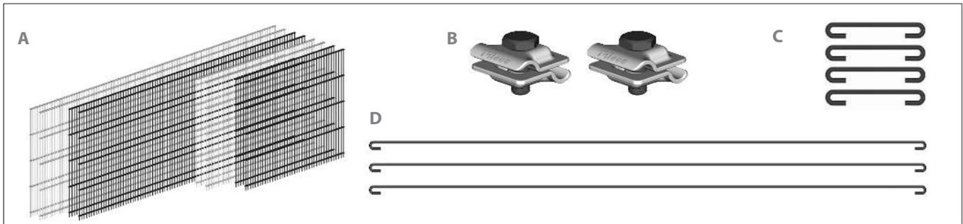
Stellen Sie eine 230 cm lange Gittermatte und eine 100 cm lange Gittermatte im rechten Winkel (90°) aneinander und verbinden Sie diese mit drei Klemmen. Ziehen Sie diese mit einem 13er-Gabelschlüssel vorerst nur handfest an.
