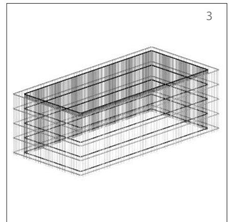
Hängen Sie nun zwischen der inneren und der äußeren Gittermatte die kurzen Abstandhalter gemäß Schema 7 gleichmäßig verteilt ein.
