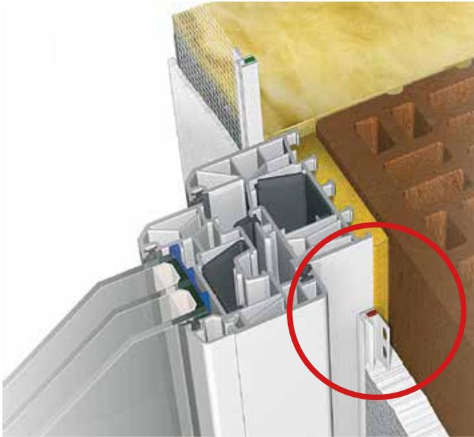
Die AnputzDichtleisten der Serie AIR gewährleisten eine luftdichte Ausbildung der inneren Anschlussfuge zwischen Innenputz und Bauelement (z.B. Fenster). Ein dauerhafter UV-Schutz des roten Schaumklebbandes ist gewährleistet.
