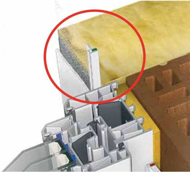
Die AnputzDichtleisten der Serie RAIN gewährleisten eine schlagregendichte Ausbildung der äußeren Anschlussfuge zwischen Außenputz und Bauelement (z.B. Fenster). Ein dauerhafter UV-Schutz des grünen Schaumklebebandes ist gewährleistet.
