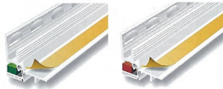
Membranleisten des „Triostop Dichtsystems“: Farblich gekennzeichnete Schaumklebebander zur Unterscheidung – rot für innen, grün für außen
