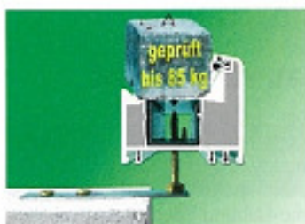
Montage mit Justa: Kein Durchbohren der unteren Entwässerungsebene
