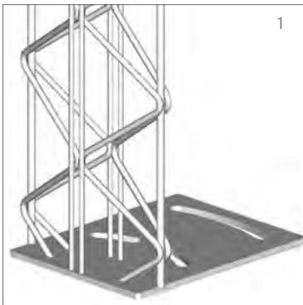
Fixer la grille frontale à l'aide des entretoises et l'accrocher avec les fixations universelles (clé à douilles de 13 mm).
