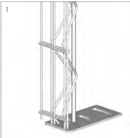
Fixer la grille frontale à l'aide des entretoises et l'accrocher avec les fixations universelles (clé à douille de 13 mm).
