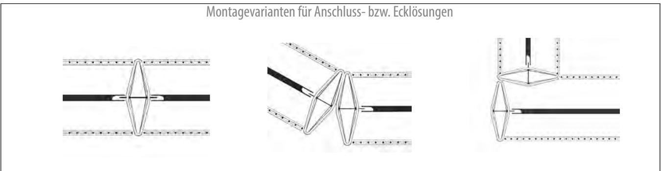
**Hinweis:** Da dem Hersteller weder Bodenbeschaffenheit noch Einsatzort bekannt sind, wird darauf hingewiesen, dass der Aufbau der Lärmschutz-Gabione eigenverantwortlich den Gegebenheiten vor Ort anzupassen und gegebenenfalls der Verwendungszweck zu überprüfen ist. Schnittstellen sind mittels Zink-Spray mit additivem Styrolalkyldharz (Salzsprühnebeltest >550h) zu versiegeln. Die Lastabtragung des Füllmaterials erfolgt über den Baugrund (Bodenpressung mind. 150 kN/m<sup>2</sup>).
