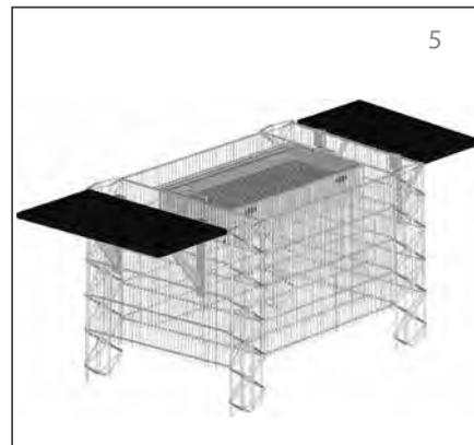
Die Lastabtragung des Füllmaterials erfolgt über den Baugrund (Bodenpressung mind. 150 kN/m<sup>2</sup>).
